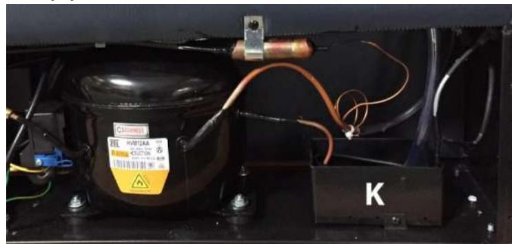
Använd vid behov en svamp för att ta bort kondensvattnet från kondensvattnetbehållaren. Den finns på enhetens baksida längst ned till höger. Ta bort metallhöljet och skruva sedan fast det igen.
