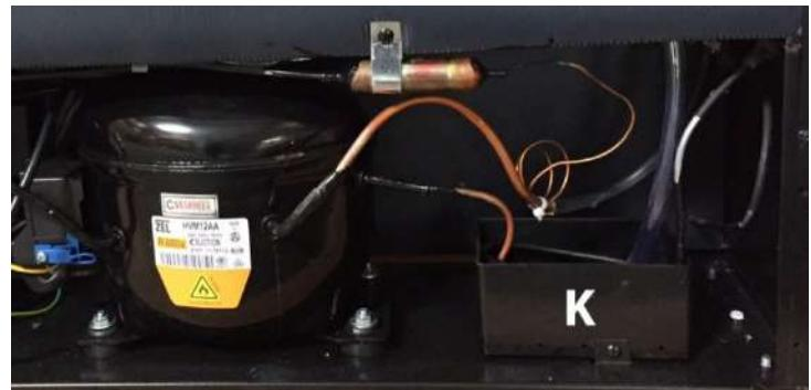
Använd vid behov en svamp för att ta bort kondensvattnet från kondensvattenbehållaren. Den finns på enhetens baksida längst ned till höger. Ta bort metallhöljet och skruva sedan fast det igen.
