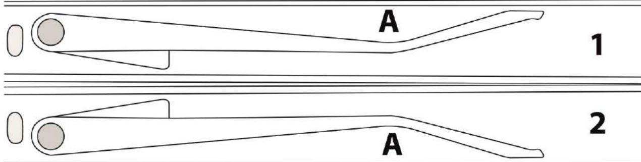
1 = unten – Lösen mit Druck an der Stelle A nach oben
