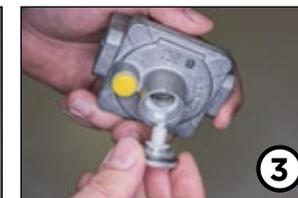
3 - L'ADATTATORE IN PLASTICA DEVE ESSERE CAPOVOLTO A SECONDA DEL TIPO DI ALIMENTAZIONE DEL GAS.
